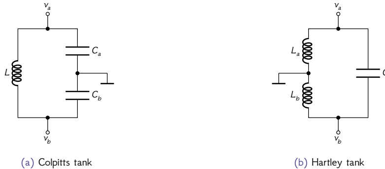
Figuur 9.7: De twee basis schema's om een LC-tank als filter te gebruiken
