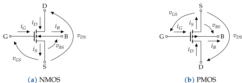
Figuur 7.4: Stroom- en spanningsconventies voor de MOSFET
